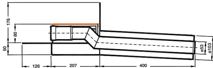
**LORO-Abzweig mit Bogen - Rohr in Rohr-**
