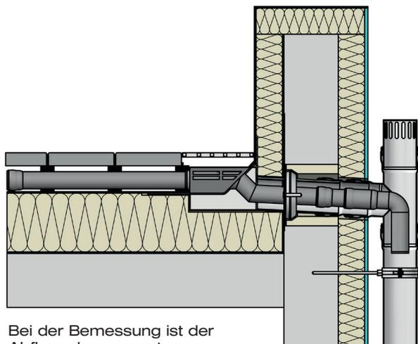
Bei der Bemessung ist der Abfluss des gesamten "STREAM" über alle Geschosse zu berücksichtigen
